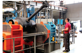
Тестирование шаровых кранов
